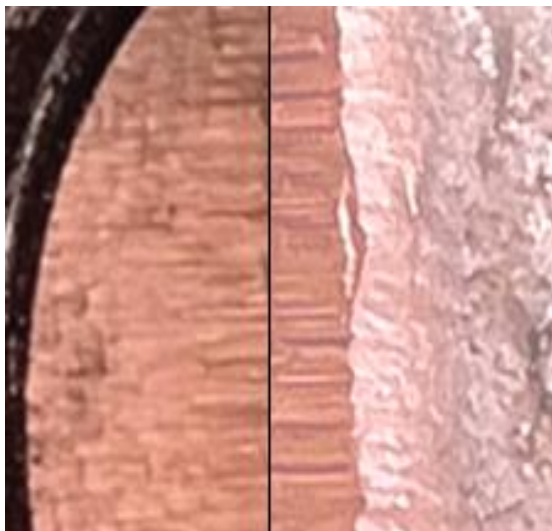
Рис. 11. Совмещение динамических следов, образованных перекусывателем педалей ПРГ-63/1, на стальных петлях
