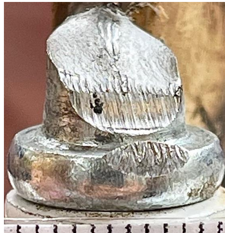
Рис. 6. След перекуса на оси петли диаметром 12 мм, образованный отрывателем петель ОПС-80Х
