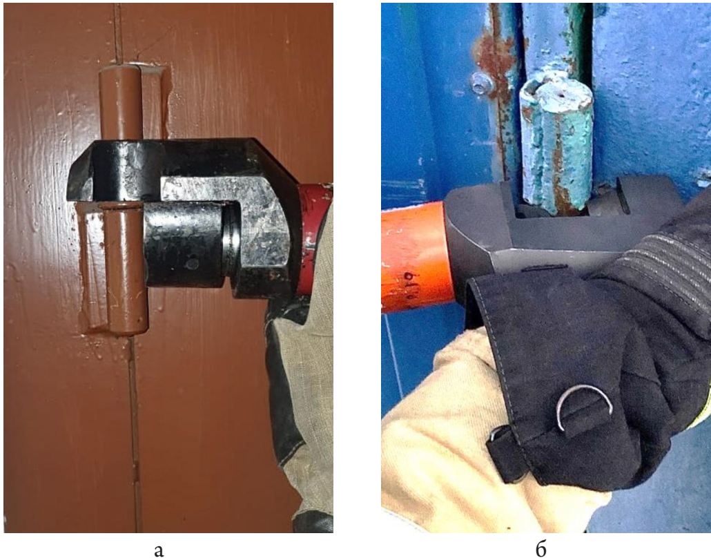
Рис. 3. Размещение гидравлического инструмента на петлях дверей в момент перекусывания: а – отрыватель петель ОПС-80Х, б – перекусыватель педалей ПРГ-63/1
