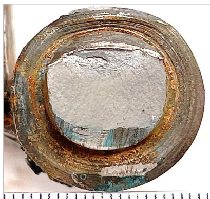
Рис. 7. Поверхность излома оси петли диаметром 22 мм, разрушенной отрывателем петель ОПС-80Х
